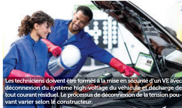
Les techniciens doivent être formés à la mise en sécurité d'un VE avec déconnexion du système high-voltage du véhicule et décharge de tout courant résiduel. Le processus de déconnexion de la tension pouvant varier selon le constructeur.
