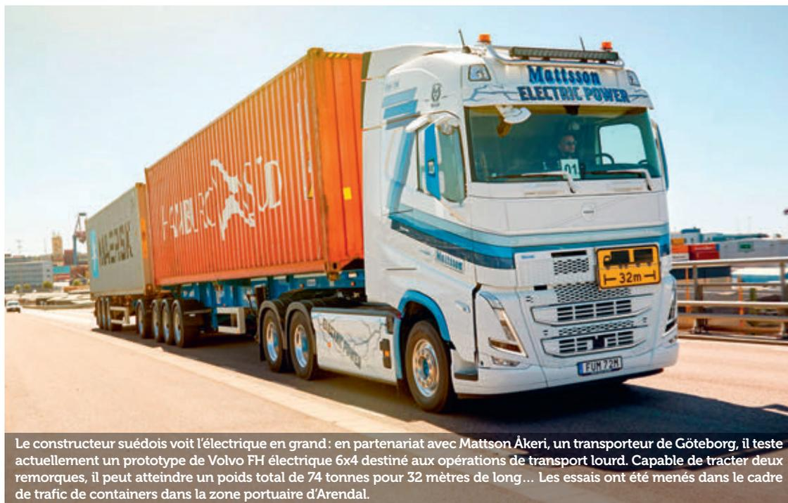
Le constructeur suédois voit l'électrique en grand : en partenariat avec Mattsson Åkeri, un transporteur de Göteborg, il teste actuellement un prototype de Volvo FH électrique 6x4 destiné aux opérations de transport lourd. Capable de tracter deux remorques, il peut atteindre un poids total de 74 tonnes pour 32 mètres de long... Les essais ont été menés dans le cadre de trafic de containers dans la zone portuaire d'Arendal.
