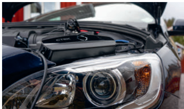
Maintenir les véhicules récents en charge durant les travaux d'entretien ou charger la batterie 12V dès l'entrée atelier est l'un des chevaux de bataille des équipementiers du secteur.
