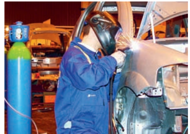
Vêtements ignifugés, tablier et gants de cuir, masque... Le carrossier doit être entièrement protégé, notamment pour les travaux de soudage.
