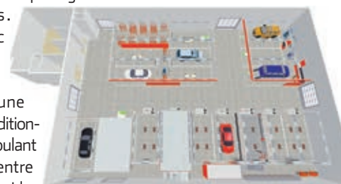
Exemple de représentation 3D d'une carrosserie conçue pour réparer huit véhicules par jour.
